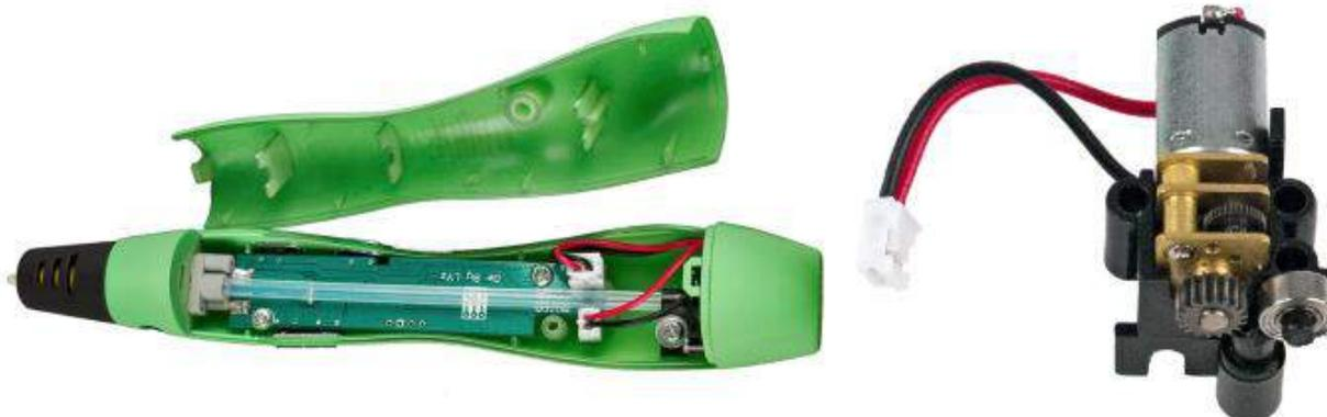
Рисунок 3 - Конструкция 3D-ручки
