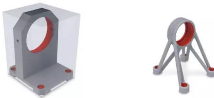
Рисунок 1 - Деталь, обработанная классическим способом из цельного куска металла, и деталь, напечатанная на принтере
