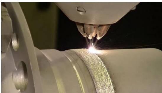
Рисунок 8 - Прямой подвод энергии и материала
