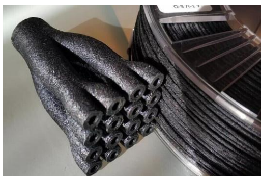
Рисунок 2 - Стеклонаполненный композит TERMAX GF-40
